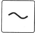
ENTRADA DE ENERGIA ELECTRICA (AC)
